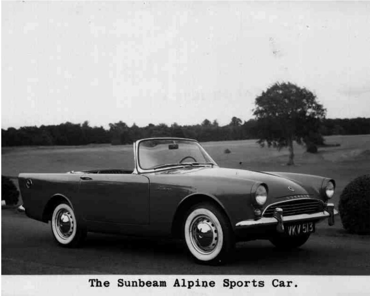
La voiture était très bien équipée pour l'époque, freins à disque à l'AV, sièges réglables en longueur, dossiers inclinables, tableau de bord très complet avec pas moins de 5 cadrans de contrôles. L'overdrive était proposé en option ainsi que le Hard-Top.
